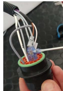
4. Identificare il filo 17 collegato al pin G del connettore X2. Tagliare il filo 17 a circa 10 cm di distanza dal connettore, e giuntare assieme i 2 terminali del filo 17 con il filo precedentemente tagliato collegato al pin J
